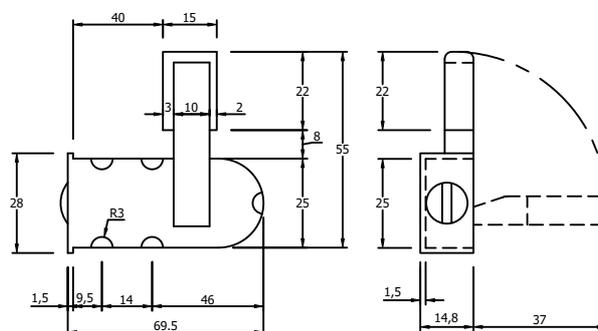
NOTA : Afin d'assurer un fonctionnement optimal du système la serrure sera systématiquement positionnée à 600mm du bas des vantaux.
