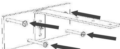
Centrer l'équerre par rapport à la platine mais ne pas bloquer l'écrou sur l'équerre, celle-ci doit pouvoir bouger lors du réglage de l'armoire-lit.
