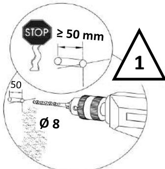
Pour les autres matériaux, utiliser des chevilles adaptées au mur (se référer aux caractéristiques techniques préconisées par les fabricants de chevilles)
